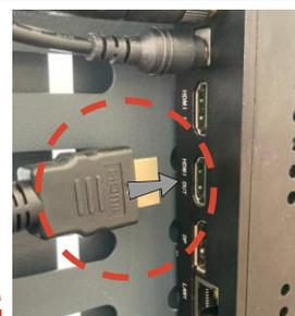
MUST MAKE SURE THAT HDMI CABLE IS FITTED INTO (HDMI OUT)
