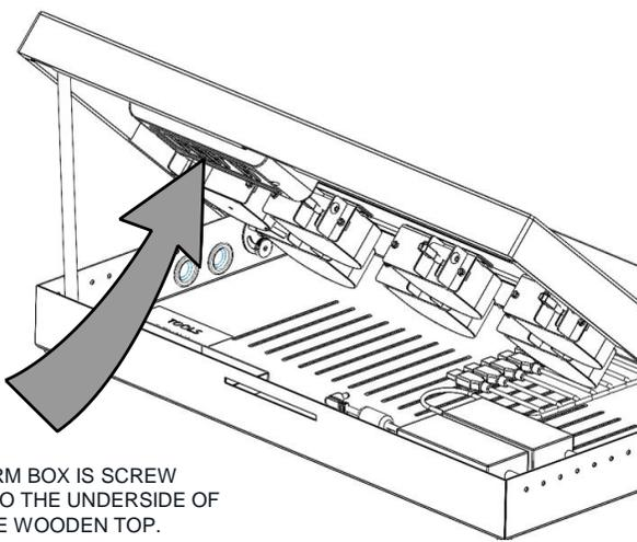
ALARM BOX IS SCREW FITTED TO THE UNDERSIDE OF THE WOODEN TOP.
